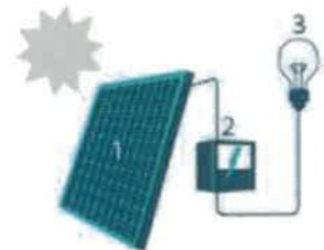
1 Zonnepaneel | 2 Omvormer | 3 Elektrische toestellen
